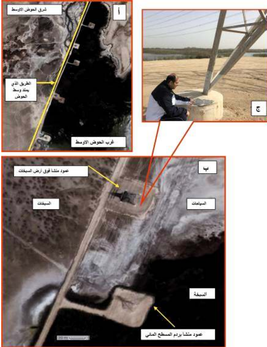
صورة (١٩) : موقع إحدى أبراج كهرباء الضغط العالي المتأثر بالتجوية الملحية في الحوض الأوسط للسبخة.
