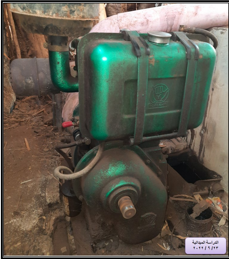
صور (٧) إحدى ماكينات رفع المياه من الآبار الارتوازية ذات قدرة (١٠ حصان/محرك)
